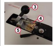
Ouvrir la pince de serrage des levées au moyen du levier excentrique (5)
