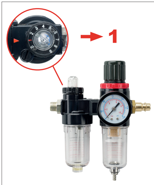
Abb. 5.1-1: Einstellung Wartungseinheit (alte Version) Artikel-Nr.: 20 218 950
