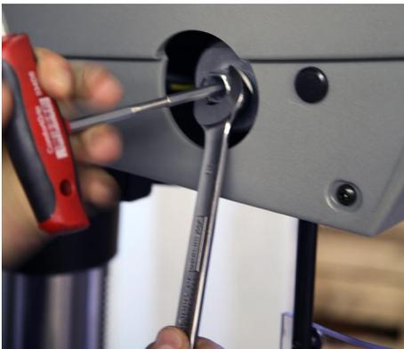
3. Lösen Sie die Spiralfeder des Bohrkreuzes, indem Sie
