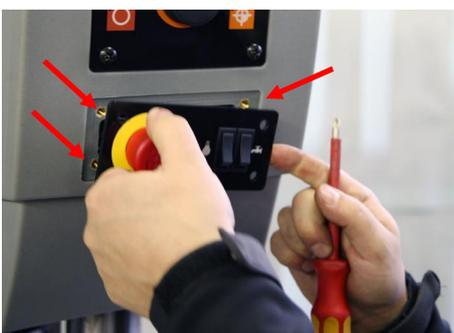
11. Befestigen Sie das Bedienpult mit Hilfe der 4 Kreuzschlitzschrauben mit der Schutzhaube.
