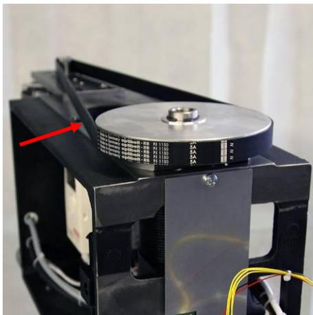
2. Kontrollieren Sie zunächst den Zustand und die Spannung des Keilrippenriemens.
