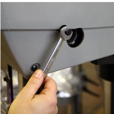
5. Schrauben Sie mit einem Sechskantschlüssel SW13 den Bohrtiefen-Anschlag auf der rechten Seite der Schutzhaube ein.
