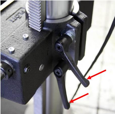
1. Lösen Sie den/die Spannhebel des Bohrtisches auf der Rückseite der Maschine.
