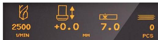
Nach dem Start der Steuerung ist immer die Bohrart *Bohren* vorausgewählt.
