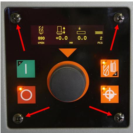
8. Befestigen Sie das Bedienpult mit Hilfe der 4 Kreuzschlitzschrauben mit der Schutzhaube.
