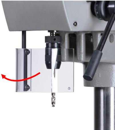
1. Schwenken Sie den Bohrschutz von Hand zur linken Seite. Dadurch wird der Bohrschutzschalter betätigt und ein Starten der Maschine verhindert.
