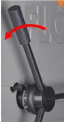
11. Führen Sie den Gewindebohrer mit Hilfe des Bohrkreuzes nun langsam in Richtung Werkstück, in dem Sie das Bohrkreuz nach unten drücken. Schneiden Sie das Gewinde in das vorgebohrte Loch des Werkstücks. Sobald die voreingestellte Gewindegrenztiefe erreicht ist, wechselt die Drehrichtung der Spindel automatisch in einen Linkslauf und der Gewindebohrer wird aus dem erstellten Gewinde geführt.
