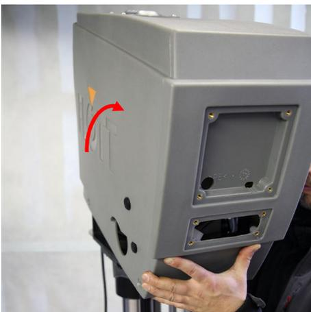
19. Kippen Sie die Schutzhaube ein kleines Stück nach vorne und ziehen Sie vom Maschinenkopf herunter.
