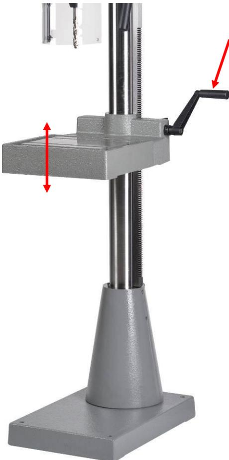
2. Verschieben Sie den Bohrtisch bis zur gewünschten Höhe, indem Sie die Handkurbel
