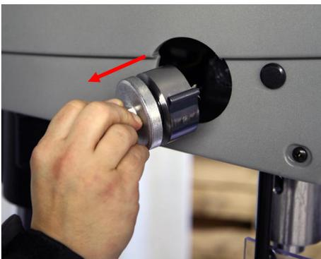
4. Entnehmen Sie die Spiralfeder aus der Schutzhaube und legen es ab.
