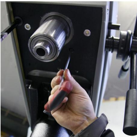
13. Schrauben Sie im Bereich der Spindel die Innensechskantschraube Größe 4 hinein, um die Ritzelwelle in ihrer Position zu fixieren.
