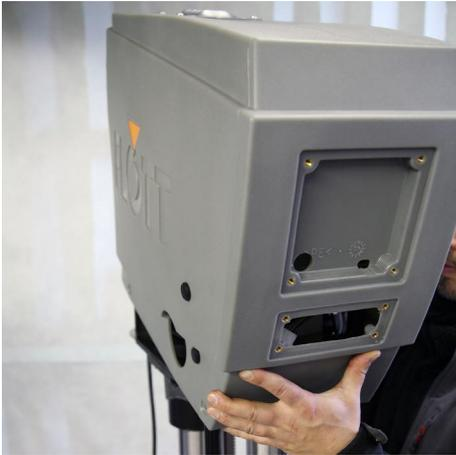
1. Setzen Sie die Schutzhaube leicht nach vorne gekippt auf den Maschinenkopf.
