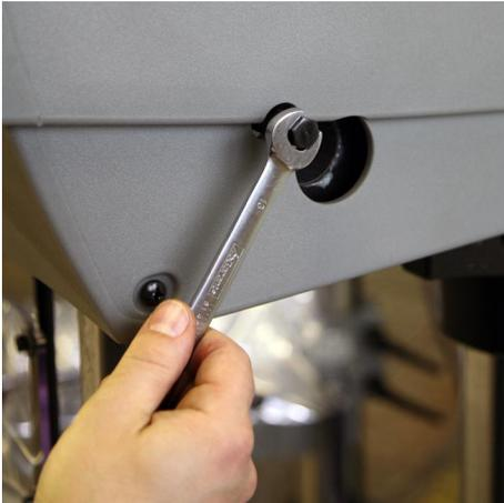
17. Lösen Sie mit einem Sechskantschlüssel SW13 den Bohrtiefen-Anschlag und entfernen diesen.
