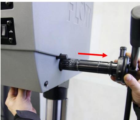
6. Ziehen Sie das komplette Bohrkreuz mit Ritzelwelle vorsichtig aus der Führung der Pinole und legen dieses ab.
