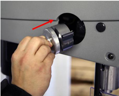
14. Drehen Sie die Pinole mit dem Bohrkreuz nach oben und setzen diese mit dem Bohrtiefenanschlag fest.
