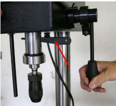
4. Drehen Sie den Bohrhebel so weit nach unten, bis die seitlichen Austreiböffnungen sichtbar werden. Halten Sie den Bohrhebel in dieser Stellung fest.
