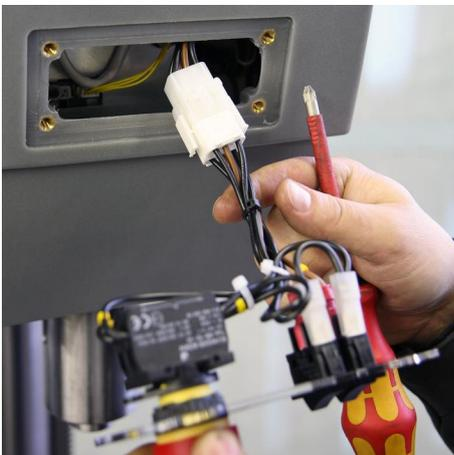
9. Stecken Sie den mehrpoligen Stecker in die Steckeraufnahme auf der Rückseite des unteren Bedienpults.
