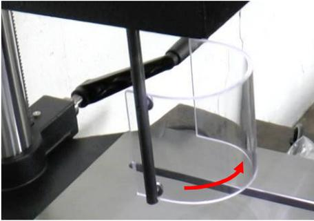
4. Schwenken Sie den Bohrschutz vor dem Start der Maschine in seine Schutzposition vor das Werkzeug. Dadurch wird der Schutzschalter betätigt, der den Betrieb der Maschine freigibt.
