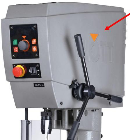
1. Entfernen Sie die Schutzhaube vom Maschinenkopf (siehe Kapitel 9.3 *Schutzhaube (de)montieren*, Seite 65). Anschließend ist der komplette Antriebsbereich inkl. Frequenzumrichter zugänglich.
