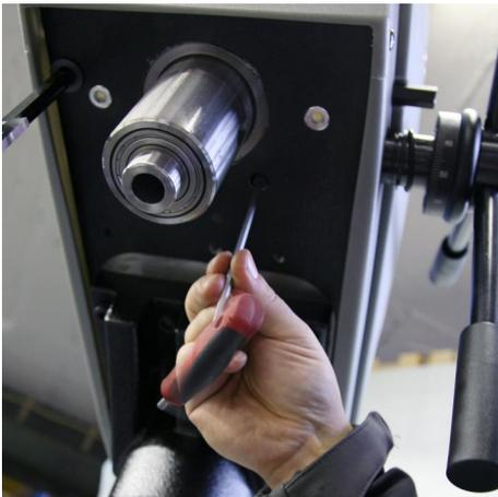
5. Lösen Sie im Bereich der Spindel die Innensechskant-schraube Größe 4, um das Bohrkreuz entnehmen zu können.
