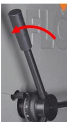
7. Führen Sie den Bohrer mit Hilfe des Bohrkreuzes nun langsam in Richtung Werkstück, in dem Sie das Bohrkreuz nach unten drücken. Bohren Sie das erste Sackloch in das Werkstück. Halten Sie das Bohrkreuz in der untersten Stellung des Bohrlochs.
