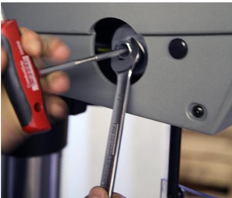
16. Schrauben Sie die Innensechskantschraube der Baugruppe von Hand etwas an.
