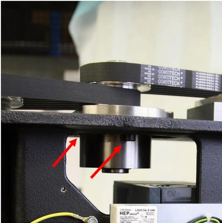
4. Lösen Sie auf der Unterseite der mittleren Achslagerung die zwei Innensechskantschrauben der Größe 6, um die Achse samt Vorgelegeriemenscheibe zu lösen. Dadurch wird die Spannung der Keilrippenriemen gelöst.
