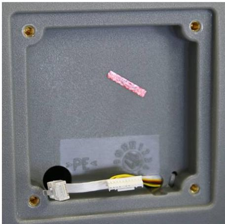
5. Entnehmen Sie das Bedienpult und tauschen es durch ein neues Bedienpult aus.
