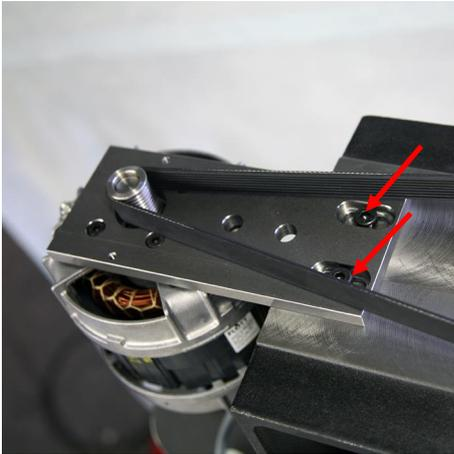
4. Lösen Sie auf der Oberseite der Motorhalterung die zwei Innensechskantschrauben, um den Motor samt hinterer Riemenscheibe zu lösen.
