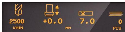
Nach dem Start der Steuerung ist immer die Bohrrart *Bohren* vorausgewählt.
