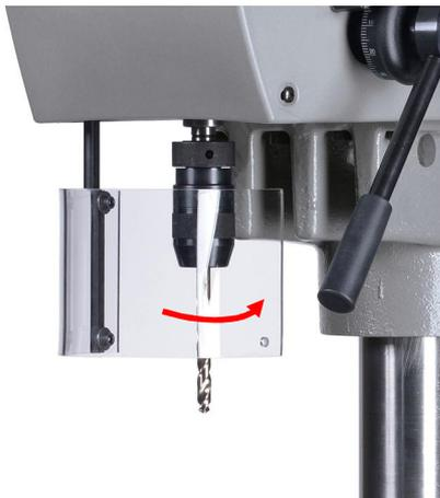
4. Schwenken Sie den Bohrschutz vor dem Start der Maschine in seine Schutzposition vor das Werkzeug. Dadurch wird der Schutzschalter betätigt, der den Betrieb der Maschine freigibt.
