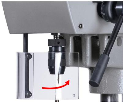
4. Schwenken Sie den Bohrschutz vor dem Start der Maschine in seine Schutzposition vor das Werkzeug. Dadurch wird der Schutzschalter betätigt, der den Betrieb der Maschine freigibt.
