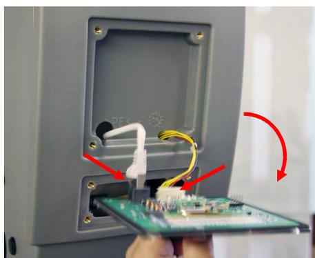
3. Klappen Sie das Bedienpult ein kleines Stück aus dem Einsatz der Schutzhaube nach unten und halten es mit einer Hand fest.
