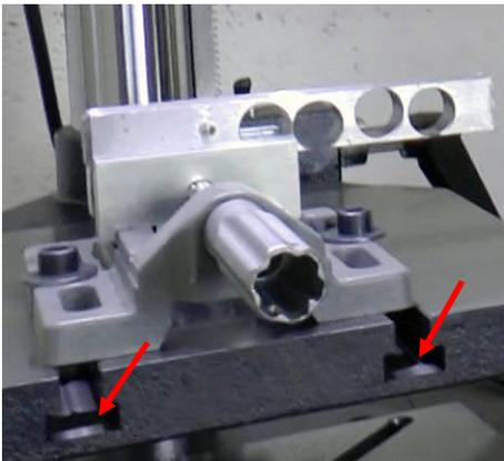
1. Schieben Sie den Maschinenschraubstock mit den T-Nutensteinen in die T-Nuten des Bohrtisches.
