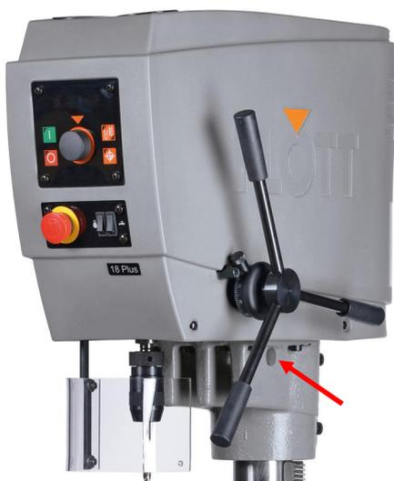
1. Stecken Sie eine geeignete Metallstange durch die Bohrung des Adapters, so dass Sie an deren Enden Tragegurte einhängen können.
