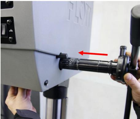
12. Schieben Sie das komplette Bohrkreuz mit Ritzelwelle langsam bis zum Anschlag in die Führung der Pinole. Dabei müssen Sie
