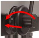
8. Schieben Sie den Festanschlag bis zum Anschlag auf die Bohrkreuzachse.
