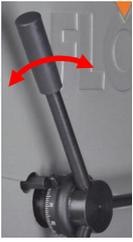
11. Führen Sie den Bohrer mit Hilfe des Bohrkreuzes nun langsam in Richtung Werkstück, in dem Sie das Bohrkreuz nach unten drücken. Bohren Sie das Durchgangs- oder Sackloch in das Werkstück. Sobald die voreingestellte Bohrtiefe erreicht ist, ertönt ein Signal („beep“). Zusätzlich wird Ihnen die Bohrtiefe im Display angezeigt.
