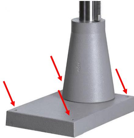
7. Versetzen Sie die Maschine ein Stück und führen die Bohrungen aus (je nach Ausführung mit 2 oder 4 Durchgangs- oder Dübellöchern für M12).
