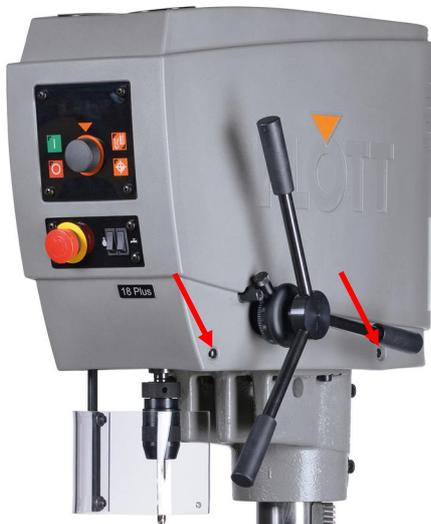
18. Entfernen Sie die jeweils 2 seitlichen Kreuzschlitzschrauben aus der Schutzhaube.
