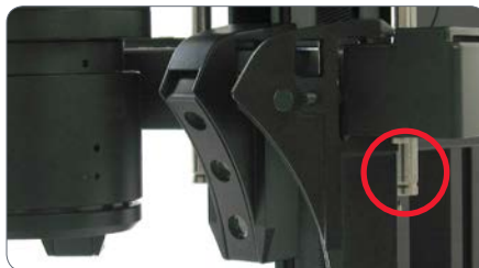
Position de montage trop haute
